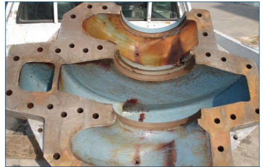
敷涂后运行3年半仍处于良好状态
