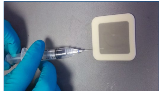
进行盐分污染检测（包括氯离子浓度测量以确保最佳的表面处理）
