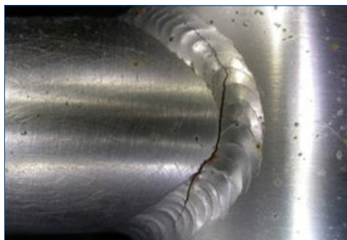
Abb. 2: Spannungsriss an einer Schweißnaht
