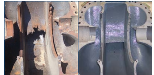
Typische Erosionskorrosion am Strömungsteiler einer Kreiselpumpe Nach Wiederaufbau und Beschichtung mit Belzona
