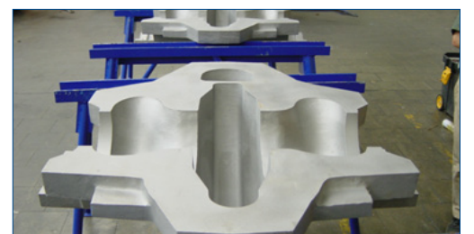
Anwendung von Belzona 1341 (Supermetalgilde) durch einen Erstausrüster
