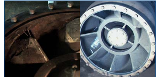
Diffuserschaufeln mit Edelstahlgewebe in situ Fertiggestellte Anwendung
