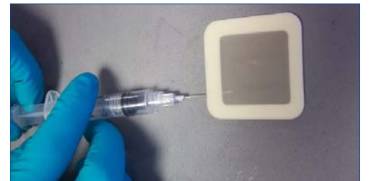
Mit gründlichem Testen auf Salzverunreinigungen (einschließlich Messung der Chlorkonzentration) wird eine optimale Oberflächenvorbereitung gewährleistet
