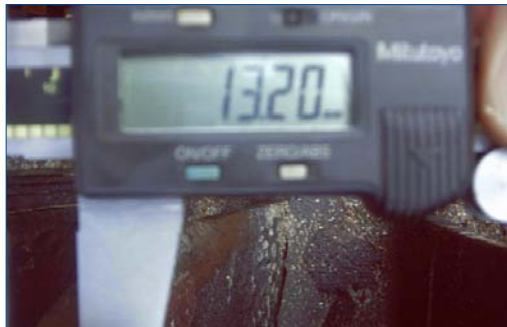
Messwert der intakten Pumpenschaufel
