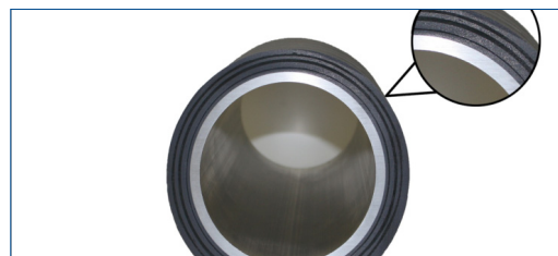
Composite de réparation à trois composants après achèvement
