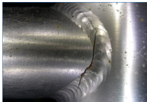
Fig 2 : Fissuration sous contrainte sur une soudure
