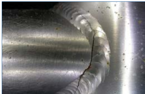
Fig. 2: Fratura por estresse em uma solda
