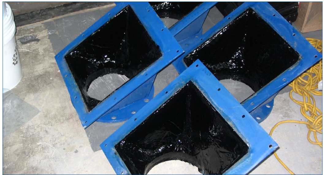
Загрузочные бункеры, облицованные материалом Belzona 2111
