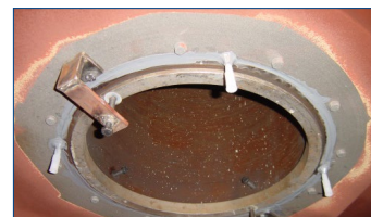
Установка подшипника руля
