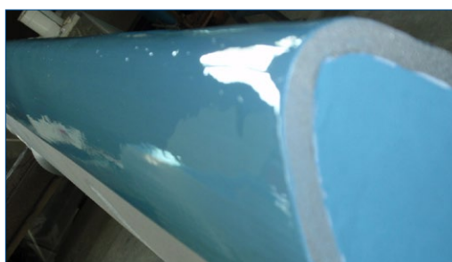
Нанесено покрытие Belzona 1341
