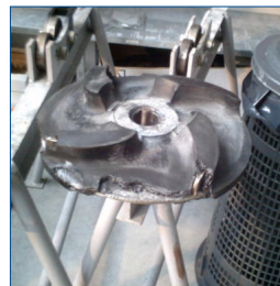
Восстановленная резиновая крыльчатка
