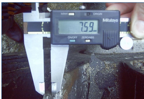
Измерение изношенной крыльчатки
