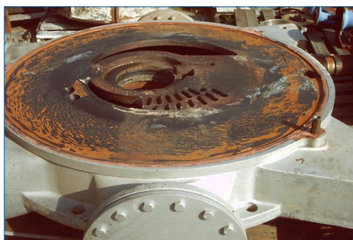
Распределительная пластина до нанесения Belzona 1111 (Super Metal)
