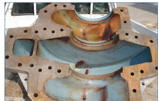
Покрытие в хорошем состоянии через 3 ½ года эксплуатации
