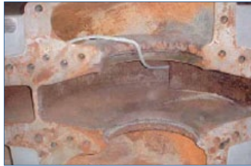
Насос, подверженный коррозии и кавитации
