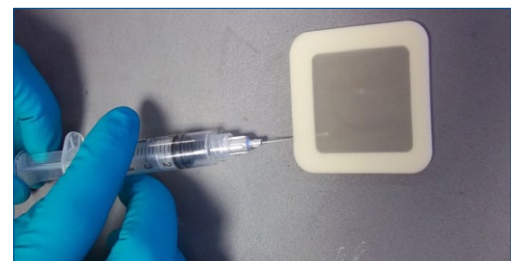
Тщательная проверка на загрязнение солями (включая измерение концентрации хлоридов) обеспечивает оптимальную подготовку поверхности
