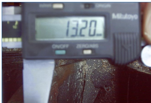
Измерение неповрежденной крыльчатки насоса
