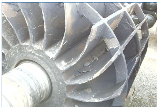
Ротор до нанесения систем Belzona 1311 (Ceramic R-Metal) и Belzona 1321 (Ceramic S-Metal)
