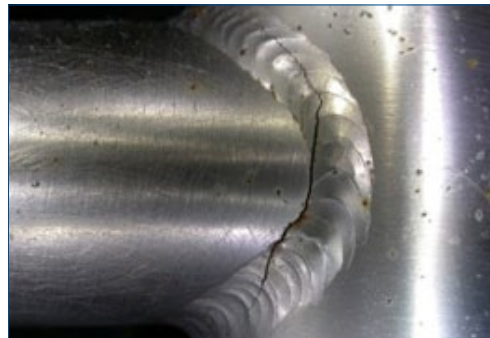
Abb. 2: Spannungsrisse an einer Schweißnaht
