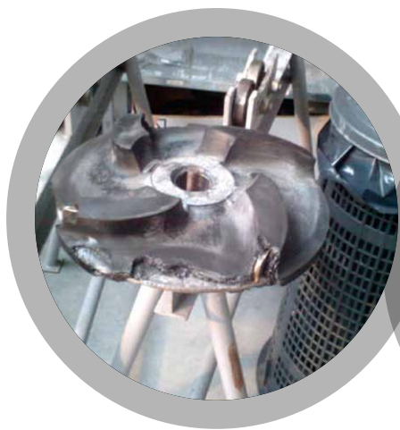
Propulsores de bombas
